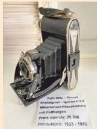
Ago Baby - Novark Anastigmat - Ikonar F 3.5 Metallornet-Klappkamera mit Falzbanen Preis damals: 25 RM Produktion: 1933 - 1942
